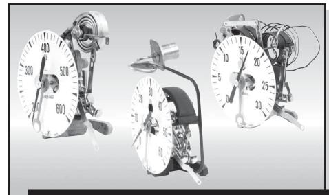
LEFT, MERCURY FILLED ELEMENT; CENTER, GAS FILLED ELEMENT; RIGHT, ORGANIC LIQUID FILLED ELEMENT
